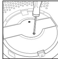
1. Stecken Sie den Luftreiniger aus und entfernen Sie den HEPA-Typ-Filter. Lösen Sie mit einem Kreuzschraubendreher (nicht im Lieferumfang enthalten) die 2 Schrauben an der Abdeckung der UV-C-Lampe.
