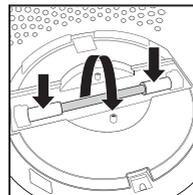
3. Schieben Sie seitlich leicht an und drehen Sie die UV-C-Lampe, um sie zu entfernen.
