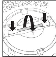
3. Irrota UV-C-polttimo työntämällä varovasti sivuilta ja kiertämällä.
