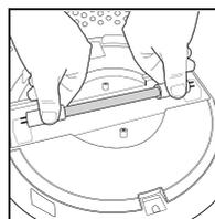
4. Wyjmij i wymień żarówkę UV-C. Ponownie załóż osłonę żarówki UV-C, filtr HEPA i osłonę kratki.
