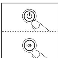
6. Steek de stekker in een standaard AC-contact en druk op de aan-knop
