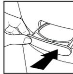
5. Setzen Sie die Ölwanne wieder in das Fach ein und drücken Sie darauf, um sie zu schließen. Der Duft startet automatisch, wenn der Luftreiniger eingeschaltet wird.
