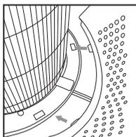
5. Aseta ritiläsuojuksen pohjassa olevat ulokkeet ilmanpuhdistimen alustaan. Työnnä ritiläsuojusta varovasti, kunnes se napsahtaa paikalleen.
