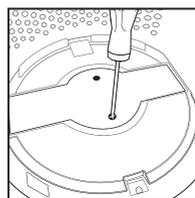
1. Odłącz oczyszczacz powietrza od zasilania i wyjmij filtr HEPA. Za pomocą śrubokręta krzyżakowego (brak w zestawie) odkręć 2 śruby mocujące osłonę żarówki UV-C.
