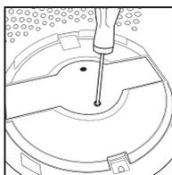
1. Koppla ur luftrenaren och avlägsna filtret av HEPA-typ. Använd en stjärnskruvmejsel (ingår ej) och skruva loss de två skruvarna som sitter på UV-C-glödlampans kåpa.
