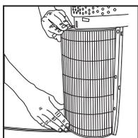
4. Vložte nový filtr typu HEPA tak, aby jeho výstupky směřovaly ven.
