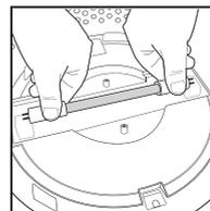
4. Extráigalo y coloque el tubo de lámpara UV-C. Ahora ya puede volver a colocar el protector, el filtro de tipo HEPA y la tapa de la rejilla.
