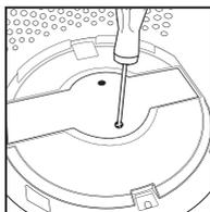
1. Débrancher le purificateur d'air et ôter le filtre HEPA. Utiliser un tournevis cruciforme (non fourni) pour dévisser les 2 vis situées sur le cache de l'ampoule UV-C.
