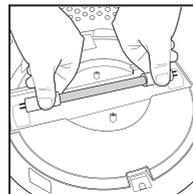
4. Entfernen und ersetzen Sie die UV-C-Lampe. Bringen Sie die UV-C-Lampenabdeckung, den HEPA-Typ-Filter und die Gitterabdeckung wieder an.
