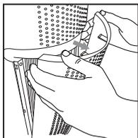
1. Húzza ki a levegőtisztító csatlakozódugóját. Húzza el a bemélyedéseket a rácsfedél mindegyik oldalán.
