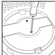
1. Scollegare il depuratore d'aria e rimuovere il filtro HEPA. Usare un cacciavite con testa Phillips (non fornito), svitare le due viti sul coperchio della lampada UV-C.
