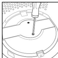
1. Odpojte čističku vzduchu z elektrické zásuvky a vyjměte filtr typu HEPA. Křížovým šroubovákem PH (není součástí balení) odšroubujte 2 šrouby nacházející se na krytu žárovky UV-C.
