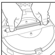
4. Verwijder en vervang de UV-C lamp. Plaats de afdekplaat, het HEPA-filter en het afdekrooster terug.
