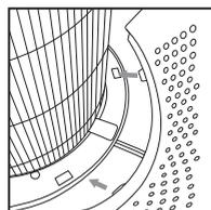
5. Umieść występy na spodzie osłony kratki, w podstawie oczyszczacza powietrza. Delikatnie pchnij osłonę kratki, aż zatrzaśnie się w położeniu końcowym.
