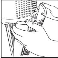
1. Desenchufe el purificador de aire. Tire de los extremos a los lados de la tapa de la rejilla.
