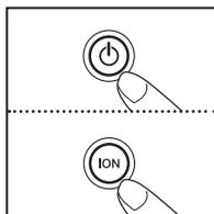
6. Csatlakoztassa a tápkábelt szabványos váltóáramú aljzathoz, és nyomja meg a főkapcsolót. Tartsa lenyomva az ionizáló ION gombját 3 másodpercig a jelző visszaállításához.
