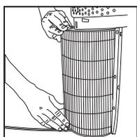
4. Posizionando le levette del filtro verso l'esterno, inserire il filtro HEPA nuovo.
