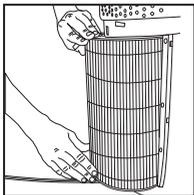
4. Aseta uusi HEPA-suodatin paikalleen siten, että suodattimen ulokkeet osoittavat ulospäin.
