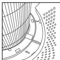
5. Posizionare le levette sul fondo della griglia di copertura nella base del depuratore d'aria. Premere delicatamente la griglia di copertura fino a farla scattare in posizione.
