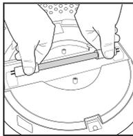
4. Avlägsna och byt ut UV-C-glödlampans. Montera tillbaka UV-C-glödlampans kåpa, filtret av EPA-typ och gallerkåpan.
