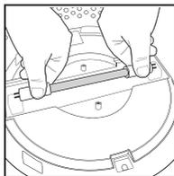
4. Fjern og skift ut UV-C-pæren. Monter dekelet til UV-C-pæren, EPA-type-filteret og gitterdekelet på nytt.
