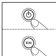
6. Collegare il cavo elettrico a una presa CA standard e premere il tasto di accensione. Tenere premuto il tasto **ION** dello ionizzatore per 3 secondi per resettare la spia.
