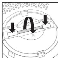
3. Žárovku UV-C vyjměte jemným zatlačením ze stran a otočením.
