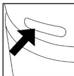
1. Tacka na olejek znajduje się z boku oczyszczacza, powyżej nocnego oświetlenia pierścieniowego.
