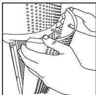
1. Débrancher le purificateur d'air. Tirer sur les emplacements prévus à cet effet de chaque côté de la grille de protection.
