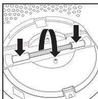
3. Pousser doucement par les côtés et tourner l'ampoule UV-C pour l'enlever.
