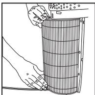
4. Con las lengüetas del filtro hacia fuera, inserte el nuevo filtro tipo HEPA.
