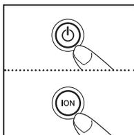
6. Enchufe el cable de alimentación en una toma de red estándar y pulse el botón de encendido. A continuación, pulse el botón **ION** y manténgalo pulsado 3 segundos para reiniciar el indicador.
