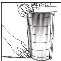
4. Setzen Sie den neuen HEPA-Typ-Filter mit den Filterlaschen nach außen ein.
