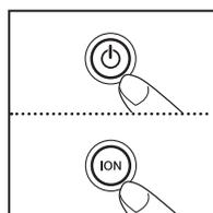
6. Podłącz kabel zasilający do standardowego gniazda prądu przemiennego i naciśnij przycisk zasilania. Następnie naciśnij i przytrzymaj przycisk **ION** przez 3 sekundy, aby zresetować kontrolkę.
