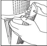
1. Stecken Sie den Luftreiniger aus. Ziehen Sie an den Vertiefungen auf beiden Seiten der Gitterabdeckung.
