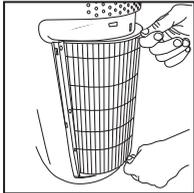
3. Poista vanha suodatin vetämällä suodattimen ulokkeista.
