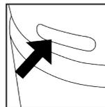
1. La bandeja para el aceite está en el lateral del purificador, encima del anillo de iluminación nocturna.
