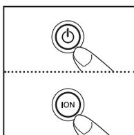
6. Stecken Sie den Stecker in eine normale Steckdose und betätigen Sie den Netzschalter. Halten Sie die Ionisator-Taste **ION** für 3 Sekunden gedrückt, um die Anzeige zurückzusetzen.
