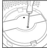
1. Desenchufe el purificador de aire y extraiga el filtro del tipo HEPA. Con ayuda de un destornillador de estrella (no viene incluido), afloje los 2 tornillos en el protector del tubo de lámpara UV-C.
