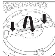
3. Tire ligeramente de los extremos y gire el tubo de lámpara UV-C para extraerlo.
