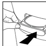
5. Vuelva a insertar la bandeja en el compartimento y empuje ligeramente hacia dentro para cerrarlo. El olor se esparcirá automáticamente al encender el purificador.
