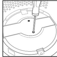
1. Irrota ilmanpuhdistimen pistoke pistorasiasta ja poista HEPA-suodatin. Avaa UV-C-polttimon kannessa olevat kaksi ruuvia Phillips-ruuvimeisselillä (ei sisälly toimitukseen).
