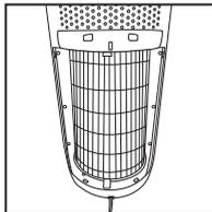
2. Entfernen Sie die Gitterabdeckung und legen Sie sie beiseite.
