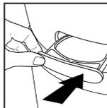
5. Riposizionare il vassoio dell'olio nell'alloggio e premere per chiudere. La fragranza inizierà automaticamente a diffondersi all'accensione del depuratore d'aria.
