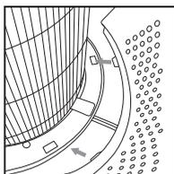
5. Schieben Sie die Laschen unten an der Gitterabdeckung in die dafür vorgesehenen Stellen unten am Luftreiniger. Schieben Sie die Gitterabdeckung vorsichtig, bis sie einrastet.
