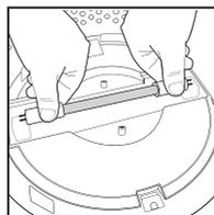
4. Vyjměte a vyměňte žárovku UV-C. Umístěte kryt žárovky UV-C, filtr typu HEPA a mřížový kryt zpět na své místo.
