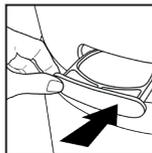
5. Umístíte olejový táč zpět do jednotky a zatlačením jej zavřete. Vůně se bude automaticky uvolňovat, jakmile se čistička vzduchu zapne.
