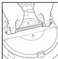
4. Rimuovere e posizionare la lampada UV-C. Riposizionare la griglia di copertura della lampada UV-C, il filtro HEPA e la griglia di copertura.
