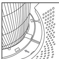
5. Placer les taquets en bas de la grille de protection dans la base du purificateur d'air. Pousser doucement sur la grille de protection jusqu'à ce qu'elle se clipse à sa place.
