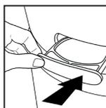
5. Replacer le plateau à huiles essentielles dans son compartiment et appuyer pour fermer. Le parfum se diffuse automatiquement lorsque le purificateur d'air fonctionne.
