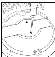
1. Koble fra luftrenseren og fjern HEPA-type-filteret. Bruk en skrutrekker (ikke inkludert) til å skru løs de to skruene på dekelet til UV-C-pæren.
