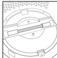
2. Entfernen Sie die Abdeckung, um die UV-C-Lampe freizulegen.
