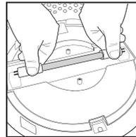
4. Poista ja vaihda UV-C-polttimo. Asenna UV-C-polttimon kansi, HEPA-suodatin ja ritiläsuojus takaisin paikalleen.
