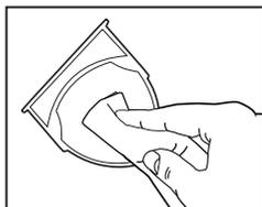
UWAGA: Na czas przechowywania urządzenia wyjmij wkład na olejek eteryczny z tacki na olejek.
