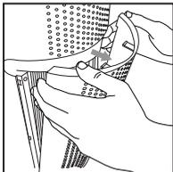
1. Haal de stekker uit het stopcontact. Trek aan de uitsparingen aan beide zijden van het afdekrooster.
