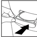
5. Sätt tillbaka oljefacket i enheten och tryck till för att stänga. Doften börjar automatiskt att spridas när luftrenaren slås på.
