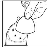
3. Aseta yksi aromityyny (toimitukseen sisältyy kolme tynnyä) öljylokeroon.
