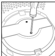
1. Haal de stekker uit het stopcontact en verwijder het HEPA-filter. Gebruik een kruiskopschroevendraaier (niet inbegrepen) om de 2 schroefjes op de afdekplaat van de UV-C lamp los te draaien.
