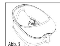
Entleerungsstutzen für das einfache Entleeren des Wassers
